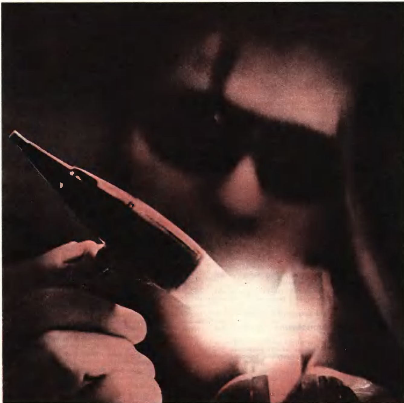
Плазменный пистолет, созданный в Киевском институте электросварки Академии наук Украинской ССР. Прибор позволяет вести различные тонкие сварочные работы — сваривание штампованных тонких пластин, пайку деталей радиосхем и т. д. Плазменный пистолет в работе.
